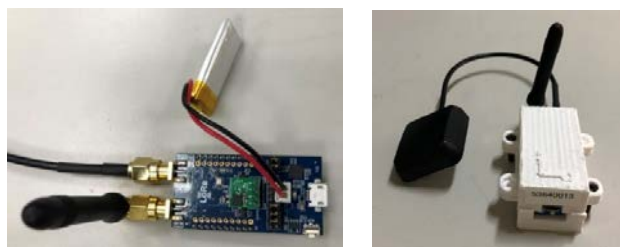
圖3：LoRa OBU配置IMU、氣壓計、Switch、獨立電源(600mAh)
